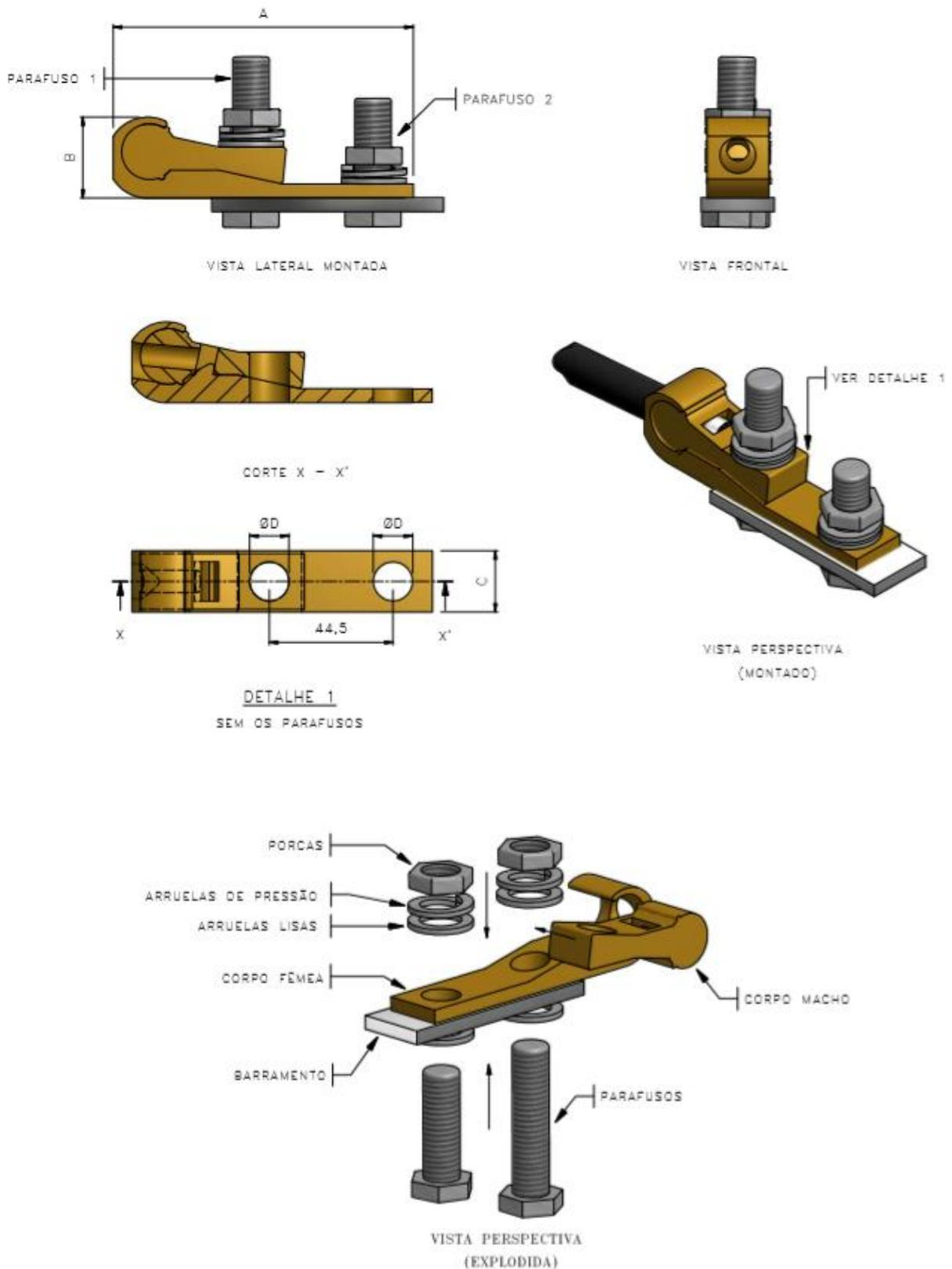
Figura 1 – Conector Terminal Tipo Travante
