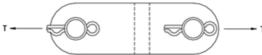
Figura 3 - Indicação de esforços para execução de ensaio
