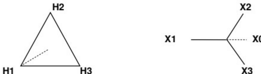
**Figura 5 - Ligação dos transformadores**
