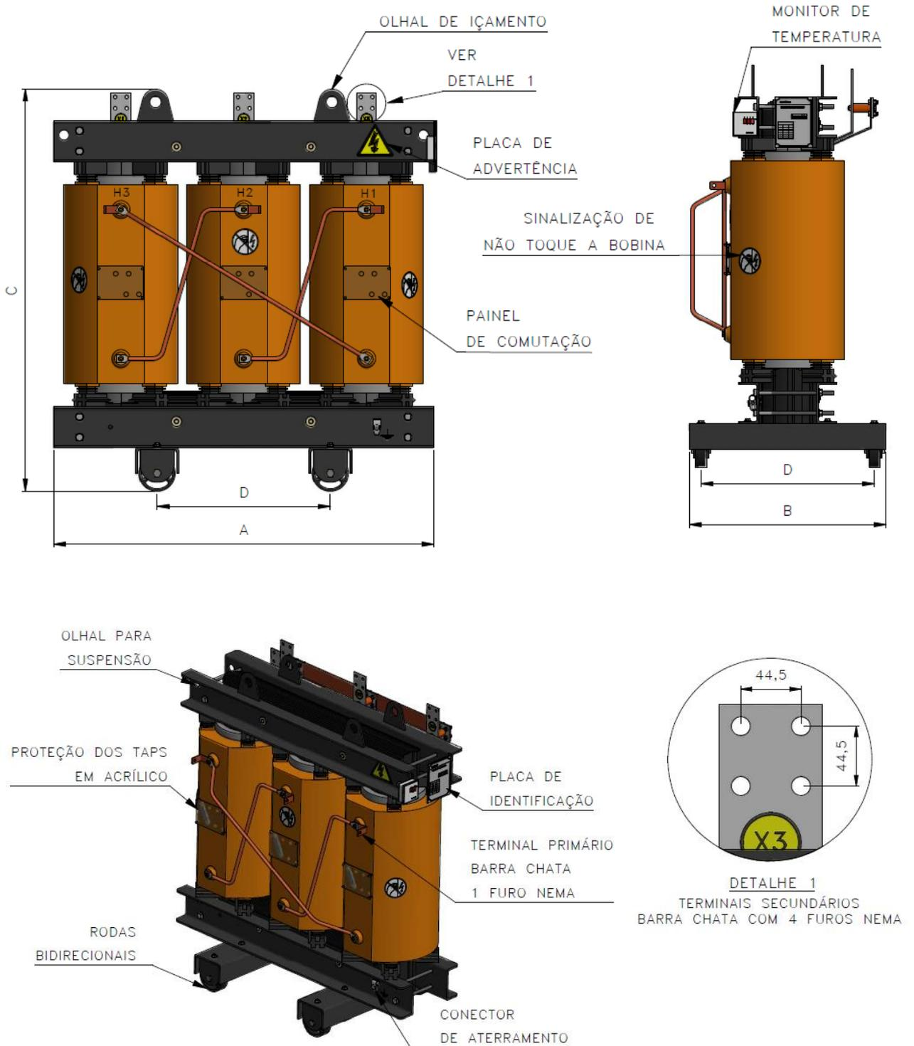
**Assunto:** Transformador de Distribuição a Seco Uso Interno
