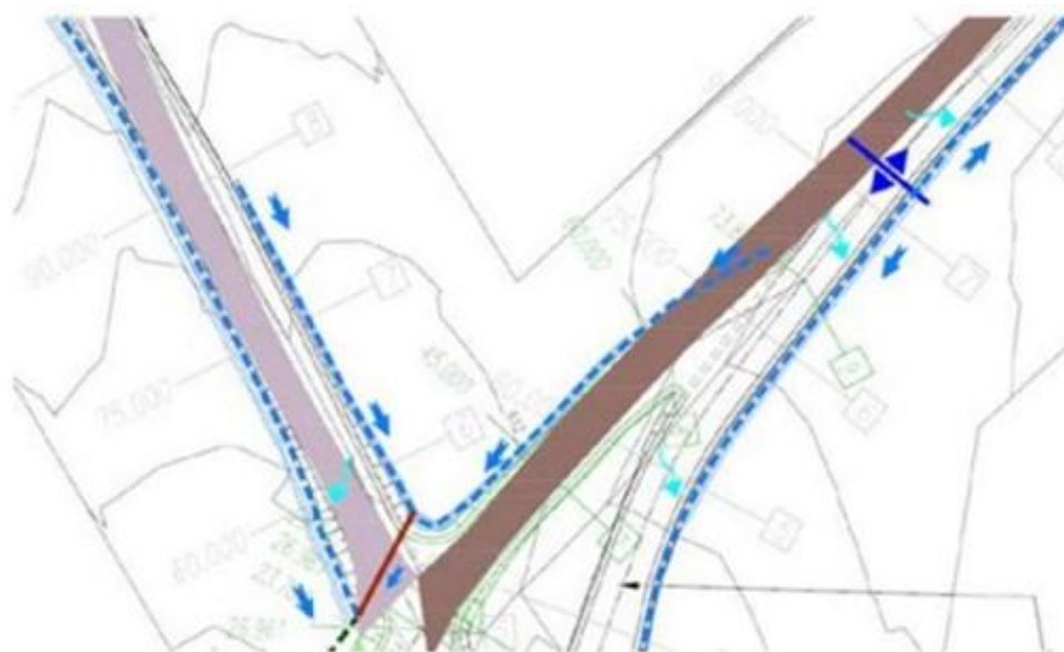
Figura 74 - Exemplo de planta que mostra as obras de drenagem da principal via de acesso à região do SED
