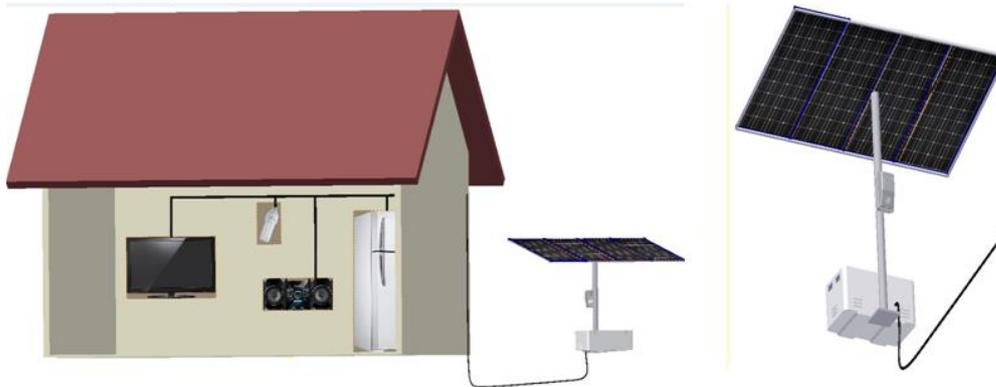
**Figura 3:** Padrão de montagem no solo
