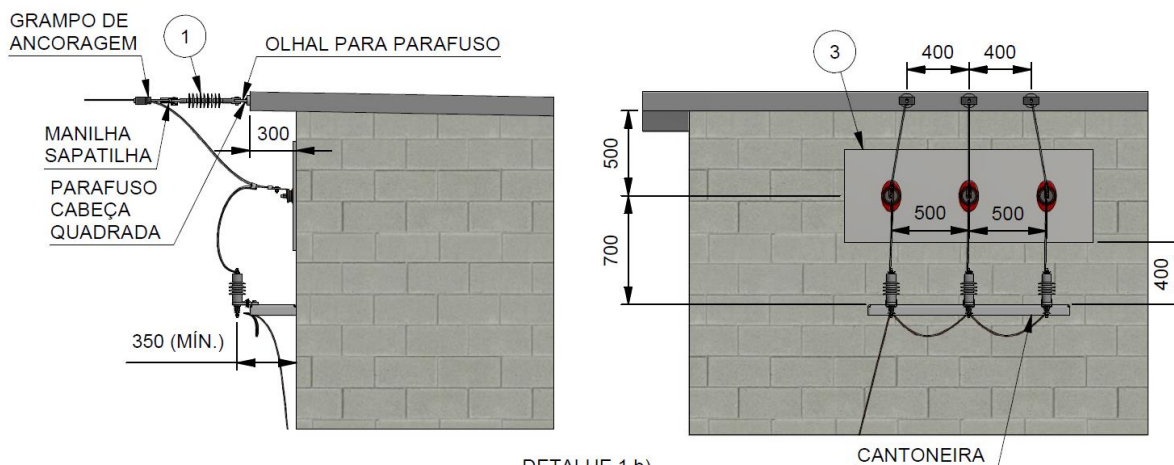
DETALHE 1.b) RAMAL DE ENTRADA - OPÇÃO PARA REDE CONVENCIONAL
