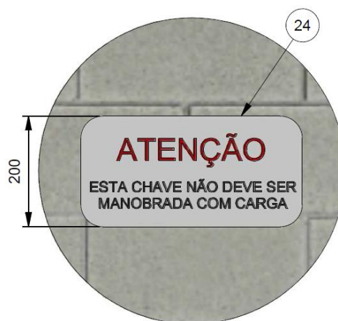
DETALHE 4 PLACA DE ATENÇÃO
