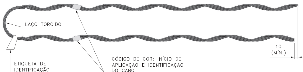
Figura 1 - Alça de distribuição em liga de cobre para condutores de cobre nus
