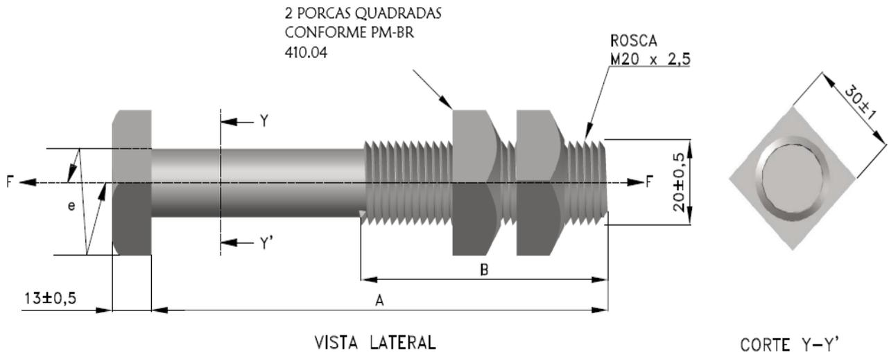
**Figura 1** - Parafuso Cabeça Quadrada M20
