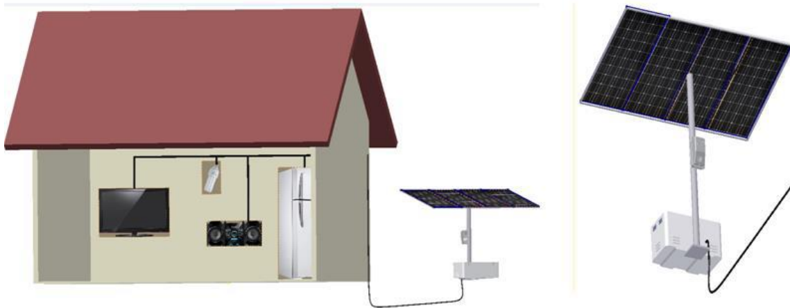
Figura 3 - Padrão de montagem no solo
