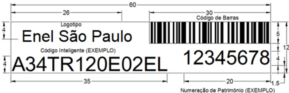
**Figura 2 - Padrão de identificação dos equipamentos de medição (medidas em milímetros)**
