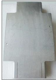
**Figura 8:** Detalhe do Suporte para Fixação da Caixa de Junção
