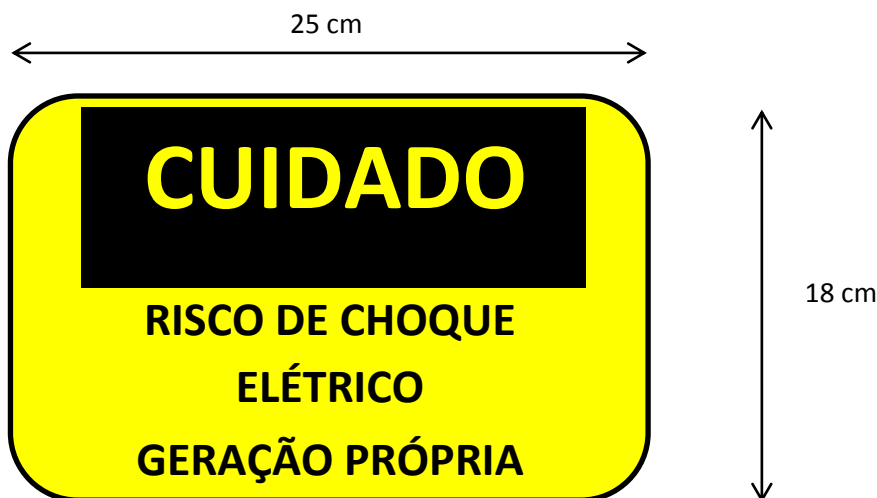
Figura 2: Placa de sinalização
