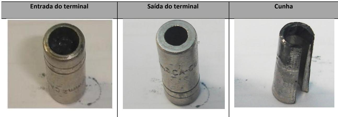
**Figura 6:** Conector cabo concêntrico de alumínio x medidor.
