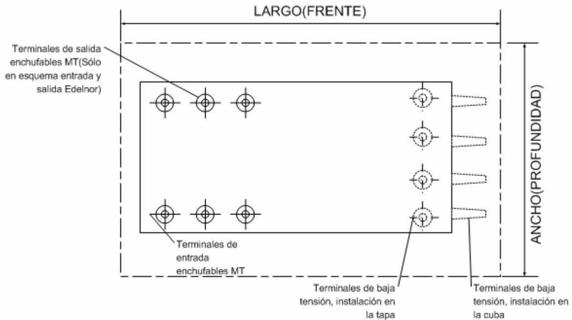
**Figura 1 :Dimensiones y disposición de elementos principales (Planta)**
