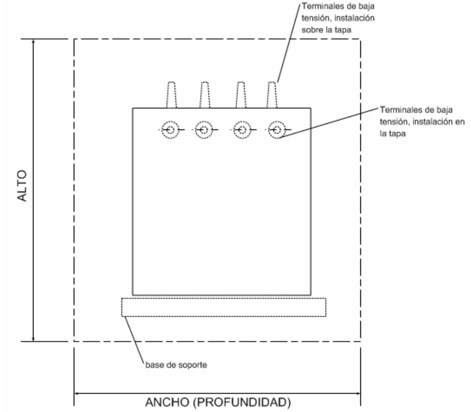
**Figura 2 : Dimensiones y disposición de elementos principales (Costado, lado baja tensión)**
