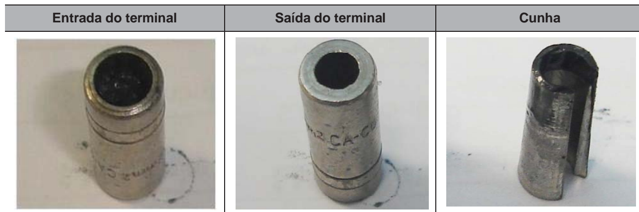
Figura 6: Conector cabo concêntrico de alumínio x medidor.
